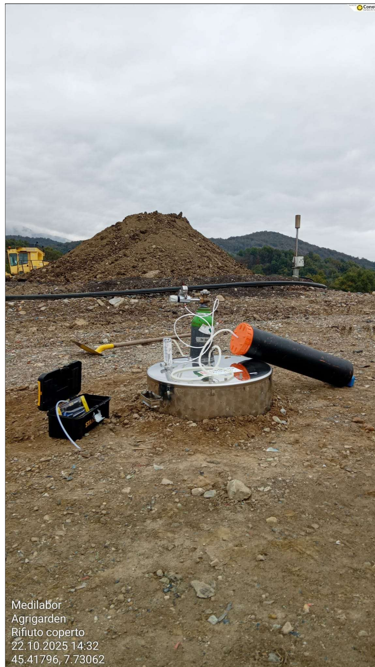
Figura 2: Strumento posizionato su rifiuto coperto con materiale terroso
