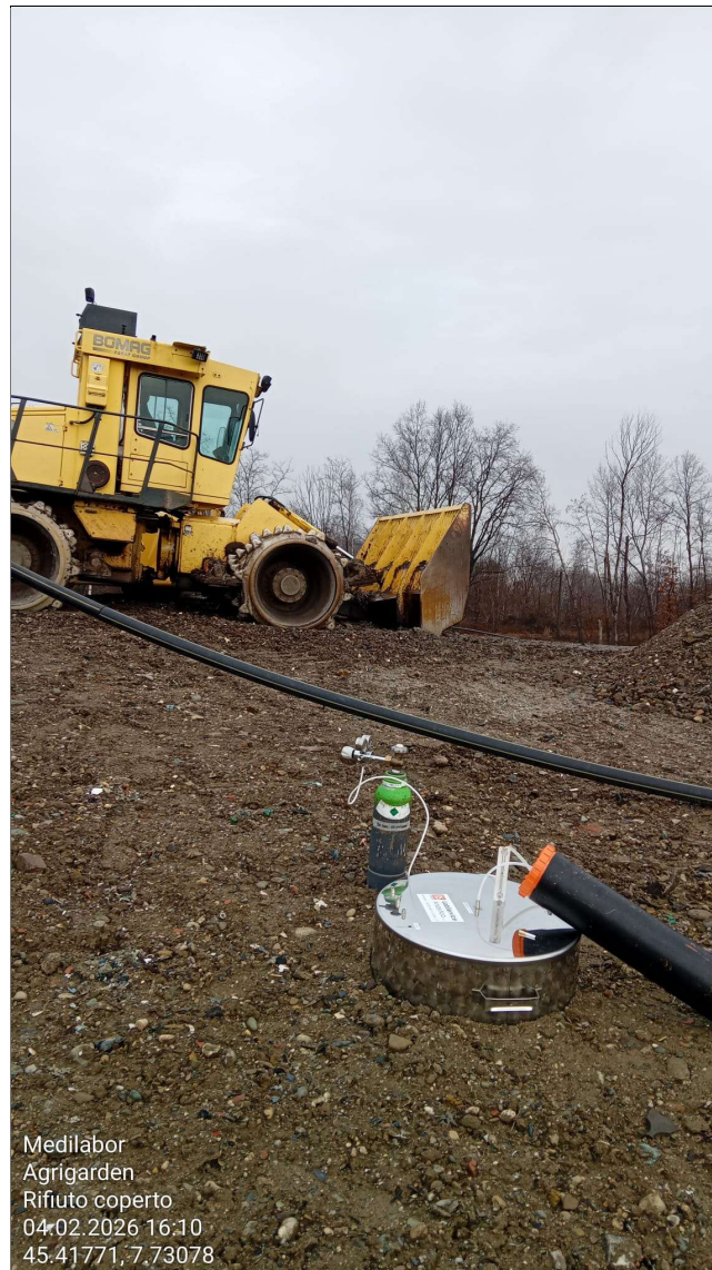
Figura 2: Strumento posizionato su rifiuto coperto con materiale terroso
